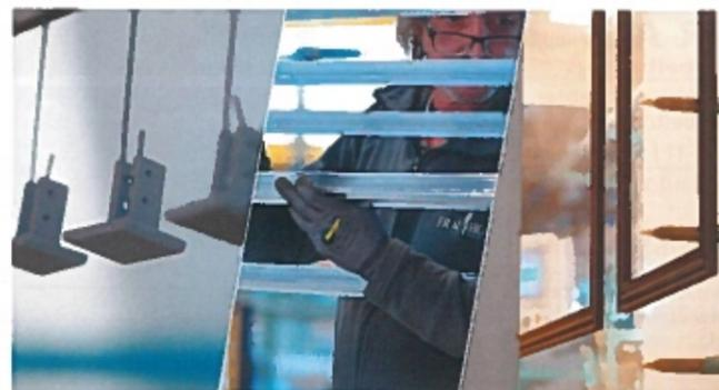
Gutmann hat am Standort Weissenburg zwei Pulverbeschichtungsanlagen errichtet, die die fertigen Elemente oder Profile hängend durchlaufen.
