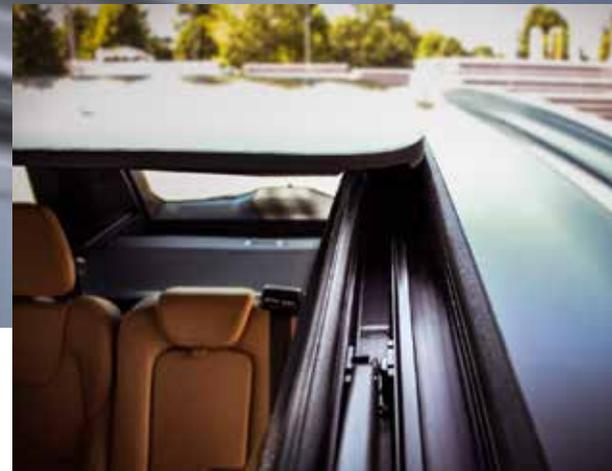
*Hochwertige Aluminiumprofile für PKW-Schiebedächer*
