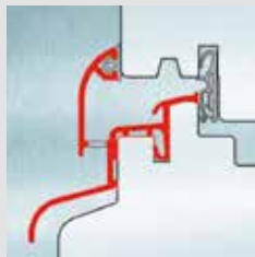
Verbundschiene mit Federsteg ohne Flügelfalz
