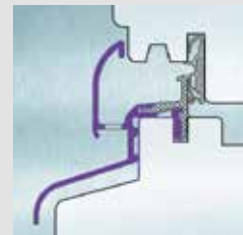
Volumschiene thermisch getrennt mit Federsteg mit Flügelfalz
