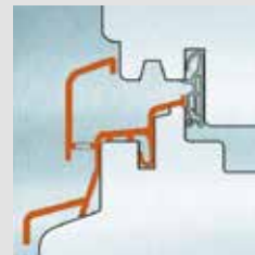
Verbundschiene mit Federsteg mit Flügelfalz
