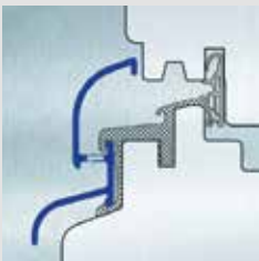
Verbundschiene thermisch getrennt mit Federsteg mit Flügelfalz
